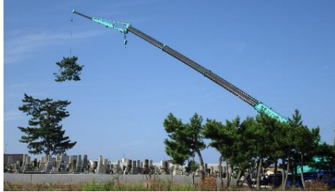
少しずつ伐採クレーンで持ち上げます
